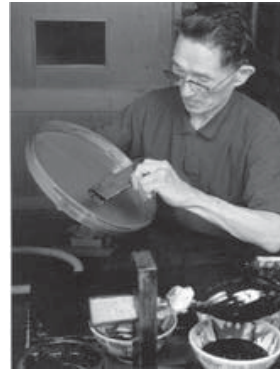
図 6-2-4 塗り師による漆塗り作業
