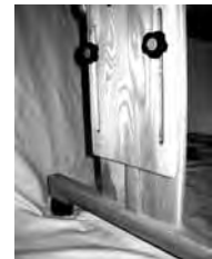
図 6-2-10 木製ワークステーション（左）とその高さ調整機構（右）
