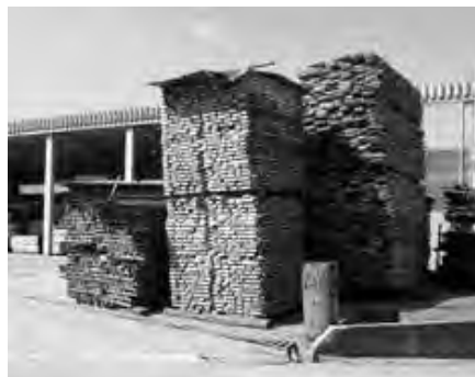
図 6-2-2 一定期間屋外で養生している様子
